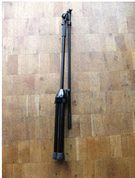
3) Die Schraube am Sockel lösen und das Standrohr soweit einschieben, dass es knapp ÜBER den Gummifüßen endet. Die Schraube am Sockel gerade ausreichend fest anziehen
